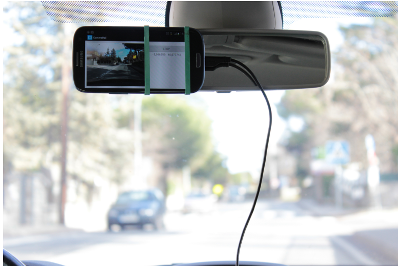
Fig. 3.1: Detalle de la fijación del teléfono móvil al retrovisor del vehículo mediante gomas elásticas
