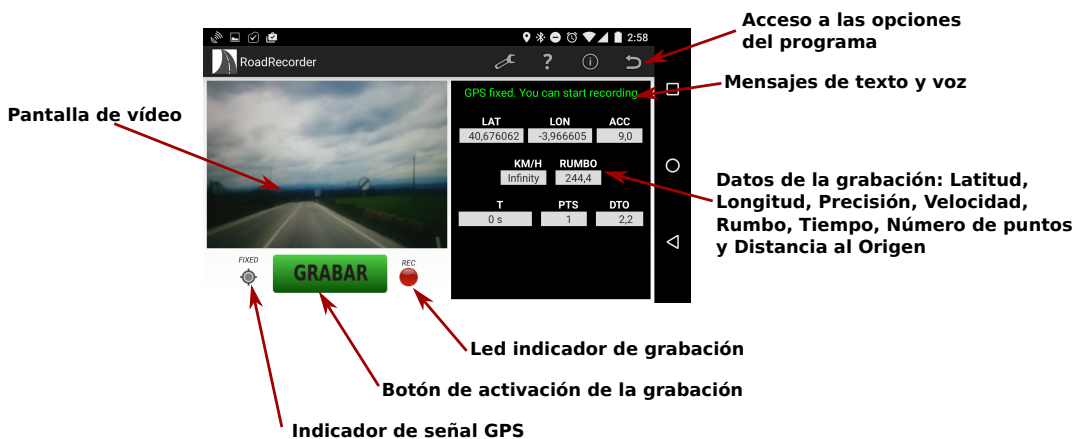
Fig. 3.2: Controles e informaciones ofrecidas en la pantalla principal de la aplicación RoadRecorder
